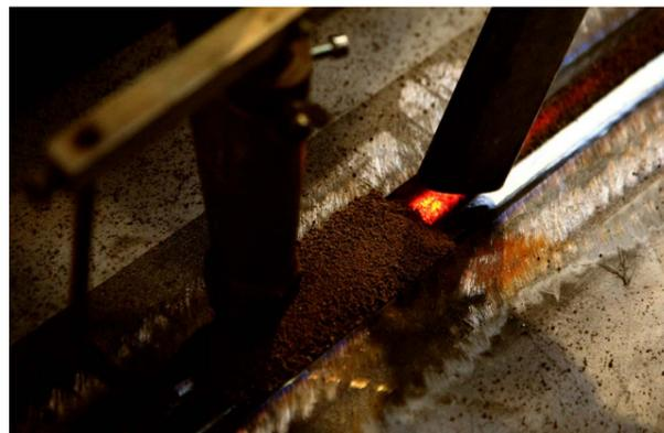
Dans les autres cas, le **soudage manuel** est privilégié. Le matériel d'apport est appliqué par un soudeur qui règle manuellement la soudeuse et manipule la source de chaleur. En fonction de la position du joint par rapport à l'opérateur on peut repérer plusieurs positions de soudage : à plat, frontale, au plafond, verticale, inclinée.
